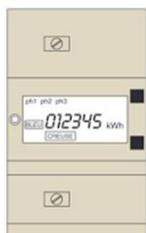
Le compteur électronique possède un écran digital et deux boutons bleus permettant de visualiser les informations essentielles du compteur. Pour connaître le relevé, il faut appuyer une première fois sur le bouton D « Défilement » (celui du bas).
